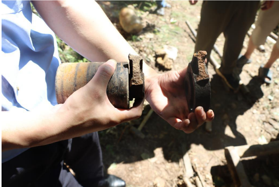
图四：张紧轮断裂口（左边金属圆柱体为飞出部位）
