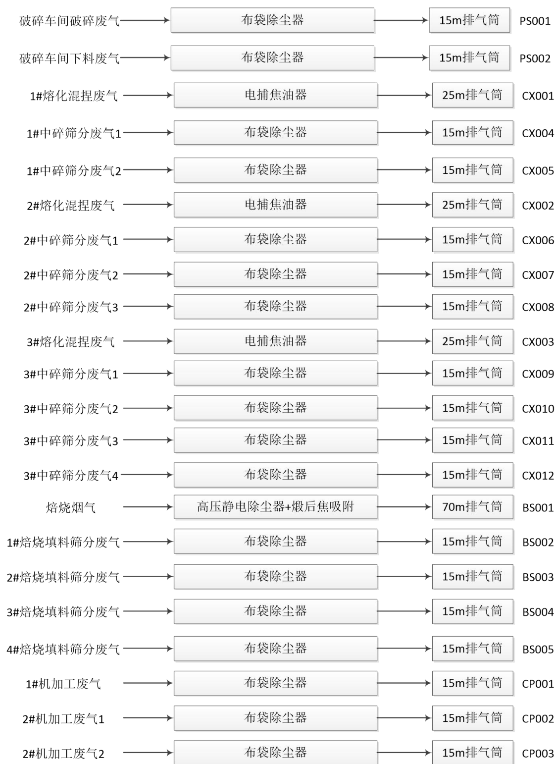
图 7.2-1 技改项目各工序废气污染防治措施流程框图
