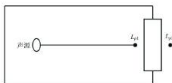
图 6.2-1 室内声源等效为室外声源图例
